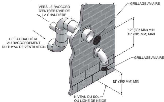
**Figure 4-2B** Autres modèles de terminaison murale en SS 701 - 801 avec raccords fournis sur place
