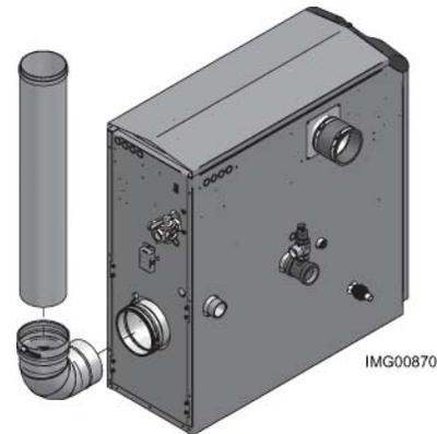
\*La ventilation murale intérieur lisse FasNSeal Flex ne s'utilise que dans les parties verticales ou presque verticales, en prenant soin de s'assurer qu'aucun affaissement ne se produit sur le circuit de ventilation. Raccorder à la ventilation rigide FasNSeal à l'aide d'adaptateurs spécialement conçus et selon la méthode de collage, voir les instructions du fabricant.
