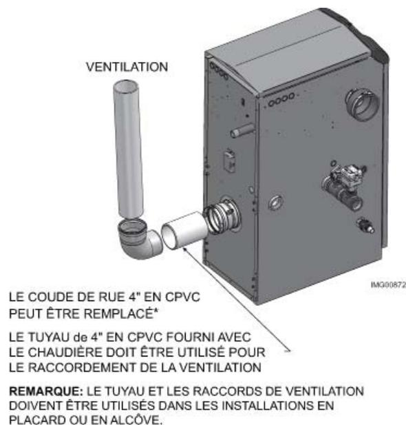
**Figure 3-3** Ventilation en PVC/CPVC à proximité de la chaudière- Modèles 701 - 801
