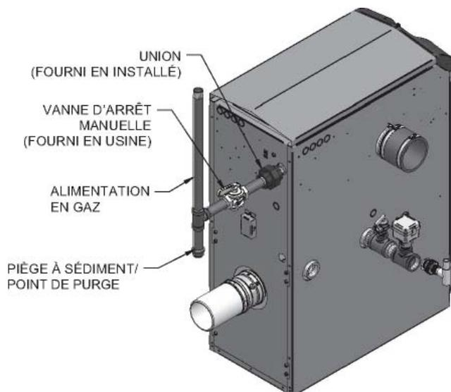
**Figure 7-3** Tuyauterie d'alimentation en gaz - Modèles 601 - 801
