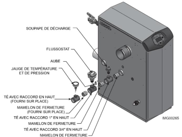
**Figure 6-2** Pose du flussostat, de la soupape de décharge et de la jauge de température et de pression\_Modèles 601 – 801
