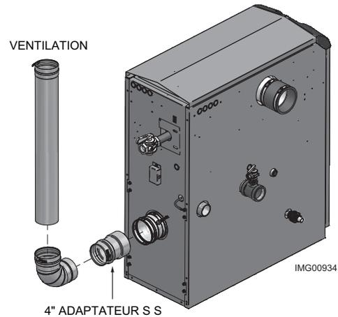
**Figure 3-7** Près de la ventilation en acier inoxydable du chaudière modèles 701 - 801
