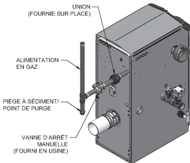
**Figure 7-2** Tuyauterie d'alimentation en gaz - Modèle 501
