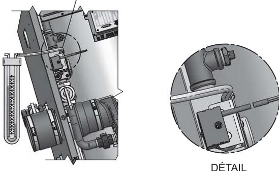
**Figure 7-7** Vérification de l'alimentation en gaz d'entrée - Modèles 601 - 801
