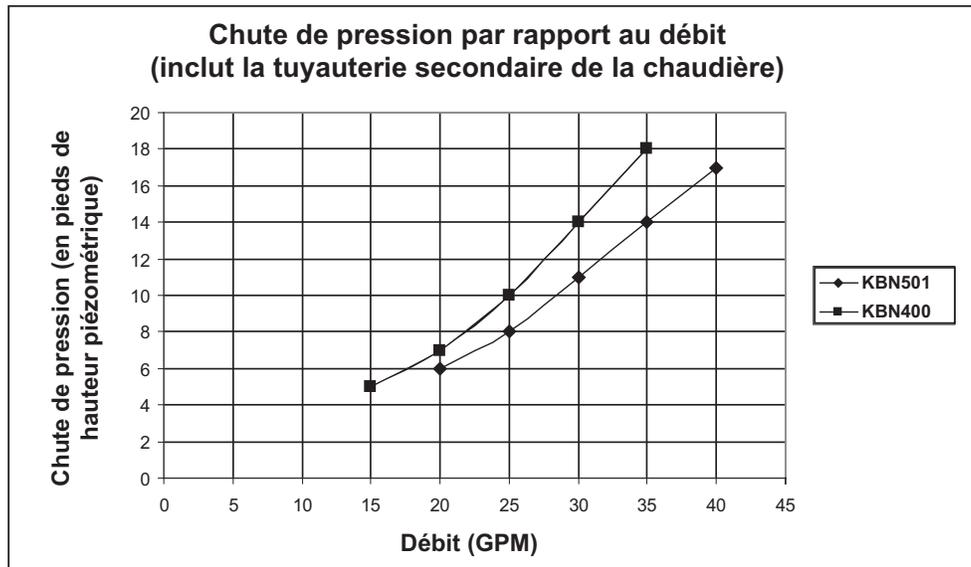
Figure 6-6 Chute de pression par rapport au débit - Modèles 601 thru 801
