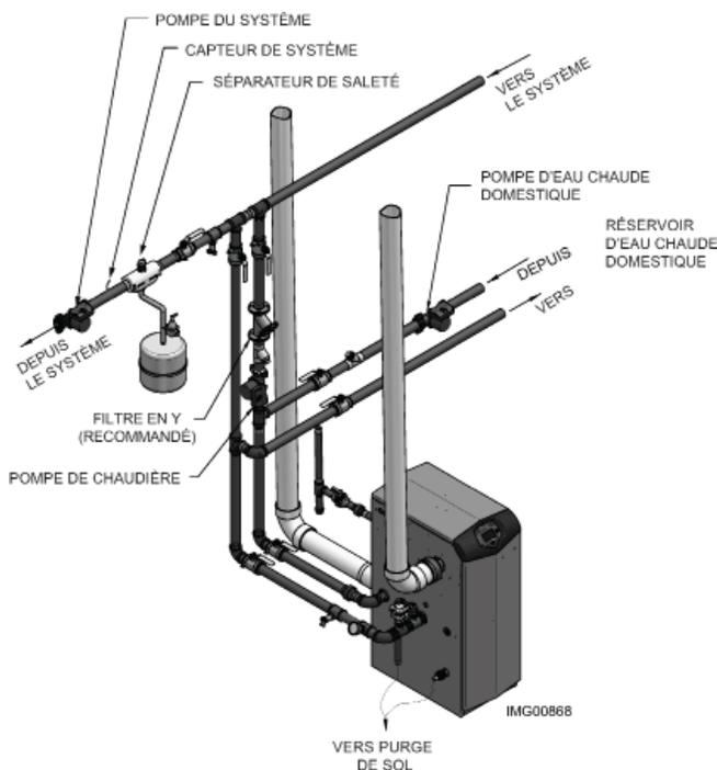
**Figure 6-4B** Tuyauterie à proximité de la chaudière avec collecteur à faible perte
